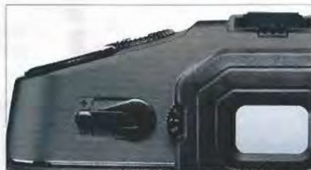
Sehr gut gelöst: Der Hebel für die manuelle Belichtungskorrektur und das Einstellrad für den Dioptrienausgleich mit exakten Werten
