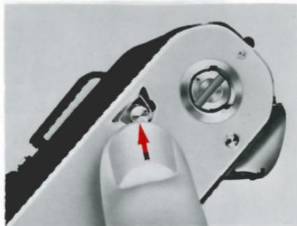
**2.** Drücken Sie den Freilaufknopf<sup>®</sup> in der Bodenplatte der Kamera. Der Knopf rastet ein, so daß ein einmaliger Druck genügt.
