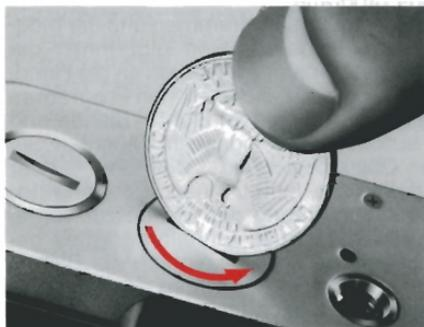
**1. Batterieklemme <sup>43</sup> entnehmen.** Schrauben Sie die Batterieklemme durch Linksdrehung mit einer Münze ab.
