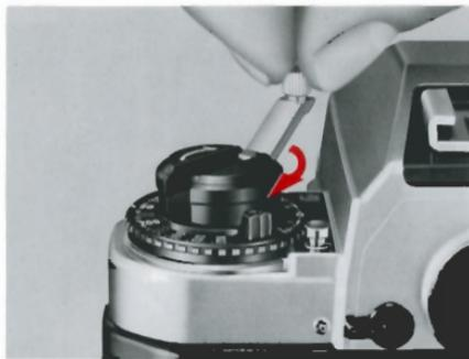
**6. Film spannen.** Klappen Sie die Rückspulkebel
