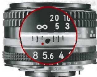
Um unwirkliche Effekte—helle Vegetation und schwarzen Himmel—zu erzielen, sollten Sie einmal Schwarzweiß-Infrarotfilm probieren. Hierfür müssen Sie ein Rotfilter (R60) vorsetzen und das Objektiv nachfokussieren, um die kürzere Schrittlänge der Infrarotstrahlung auszugleichen. Die meisten Objektive besitzen hierfür einen Infrarotindex  $\ast$  in Form eines roten Punktes oder Striches neben dem Einstellindex  $\ast$ . Für die Scharfeinstellung verfahren Sie wie folgt:
