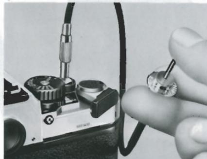
Zur Aufnahme drücken Sie den Auslöser voll durch. Über Sie diesen Druck gleichmäßig mit der Kuppe des Zeigefingers aus, um jegliches Verreißen der Kamera—und damit Verwacklungsunschärfe—zu vermeiden. In der Mitte des Auslösers befindet sich eine Gewindebuchse, die einen Drahtauslöser aufnimmt, wie er sich für Stativaufnahmen empfiehlt.
